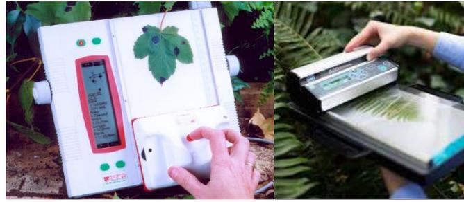
بعض اشكال جهاز قياس المساحة الورقية Portable Leaf Area Meter
