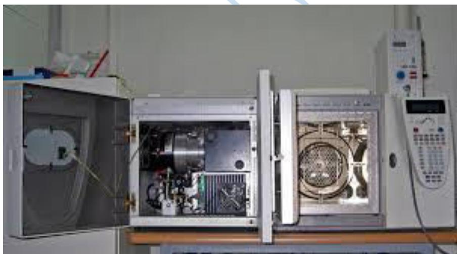
صورة جهاز متقدم لكروماتوغرافيا الغازات وهو يسجل درجات تركيز acrylonitrile في الهواء عند عدة نقاط في أرجاء المعمل الكيميائي
